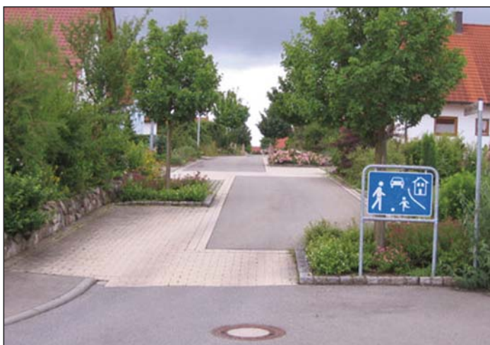
Slika 25. Uzastopne vodoravne devijacije s hortikulturom na početku prometnice u kojoj se smiruje promet
